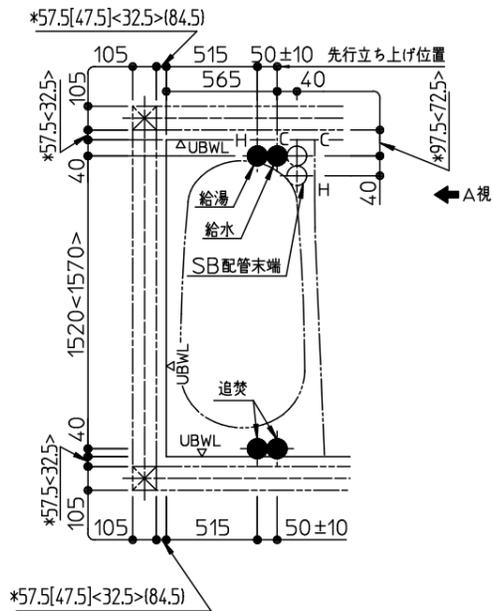
給水・給湯管は、基本仕様が壁裏配管となります。
