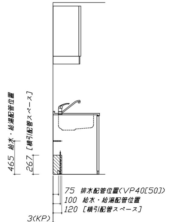
Zシンク給水排水配管例図
