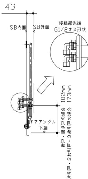
〈給水給湯管取合詳細図〉
